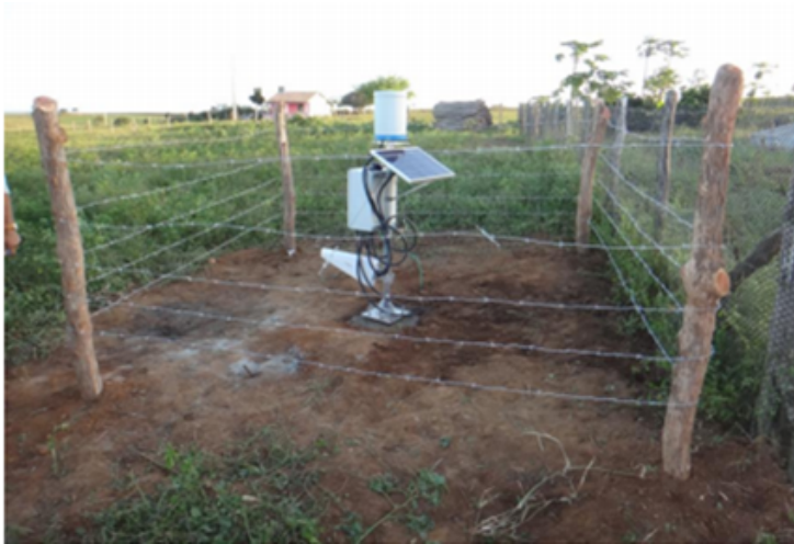
PCD Agrometeorológica instalada em cercado
